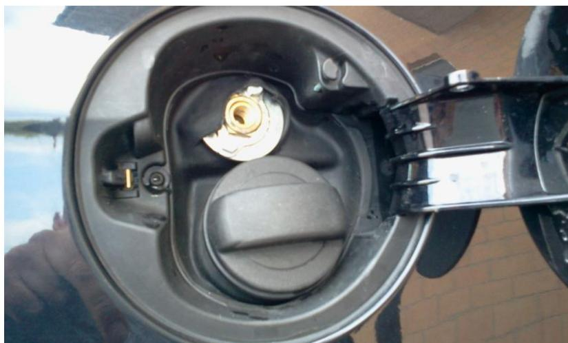
La valvola di riempimento è una valvola per caricare il carburante dei veicoli alimentati a GPL. E' posizionata vicino al tappo del serbatoio della benzina nello stesso compartimento o in altra posizione grazie al suo appropriato alloggiamento plastico.
