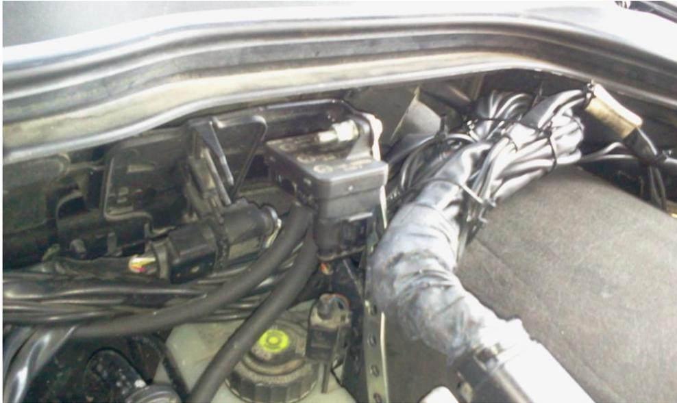
Questo componente viene utilizzato nei veicoli bifuel GPL. Misura la pressione dopo il regolatore di pressione e il vuoto al collettore di aspirazione. I segnali di pressione vengono trasformati in segnali elettrici in modo da poter essere analizzati dalla centralina ECU.
