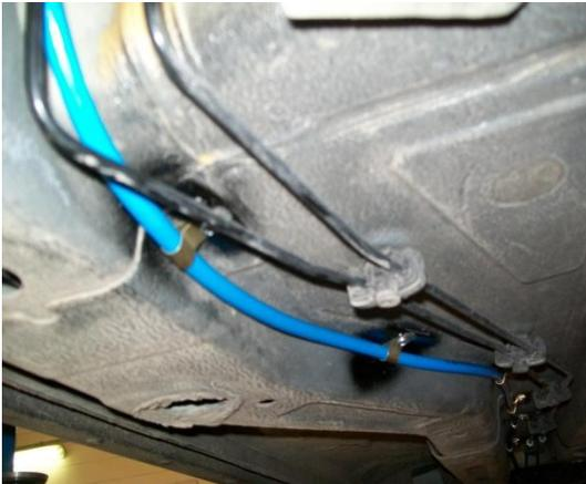
Anima interna in poliestere termoplastico, rinforzo con singola treccia in fibra di poliestere e ricopertura esterna in poliuretano antiabrasione, stabilizzato ai raggi UV e resistente ai microrganismi.
