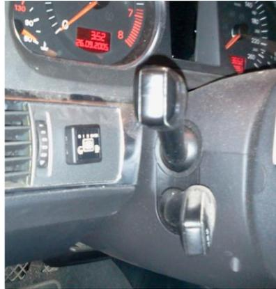
Questo componente è utilizzato in veicoli bifuel a doppia alimentazione gas e benzina. Entrambi i funzionamenti possono essere selezionati dall'utilizzatore grazie alla pressione sul tasto bianco. I led verdi mostrano il livello di gas nel serbatoio.
