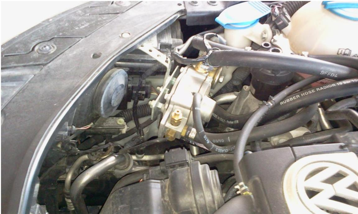
Il riduttore Mg motor Gas vaporizza il Gpl liquido e regola la pressione in uscita mediante uno stadio di riduzione della fase gassosa tra 0,7 e 1,5 bar indicativamente. La pressione si intende come relativa, poiché tramite la presa di compensazione si preleva il segnale della pressione collettore. La pressione in uscita è regolabile tramite l'apposita vite nel coperchio superiore.
