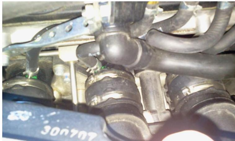
Posizionare gli iniettori con ugelli strozzatori diam 2,6 mm utilizzando per il fissaggio, le viti già presenti sui collettori per il sistema di alimentazione originale del veicolo Effettuare i collegamenti pneumatici del tubo segnale di pressione verso il sensore di pressione e del tubo mandata gas tra iniettori e filtro.
