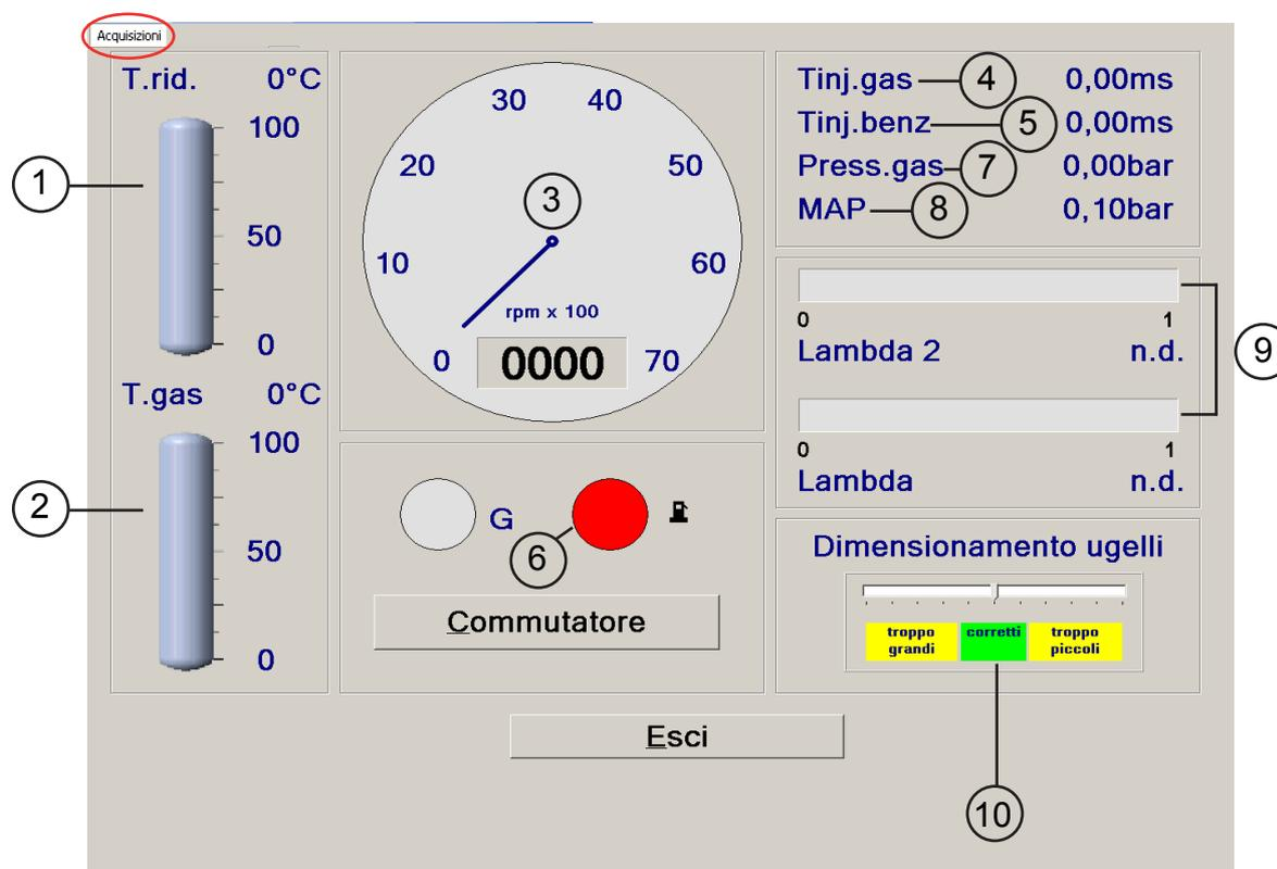
**Acquisizioni:** Permette la memorizzazione dei parametri di funzionamento della centralina GAS in un file che può essere visualizzato tramite un grafico.
