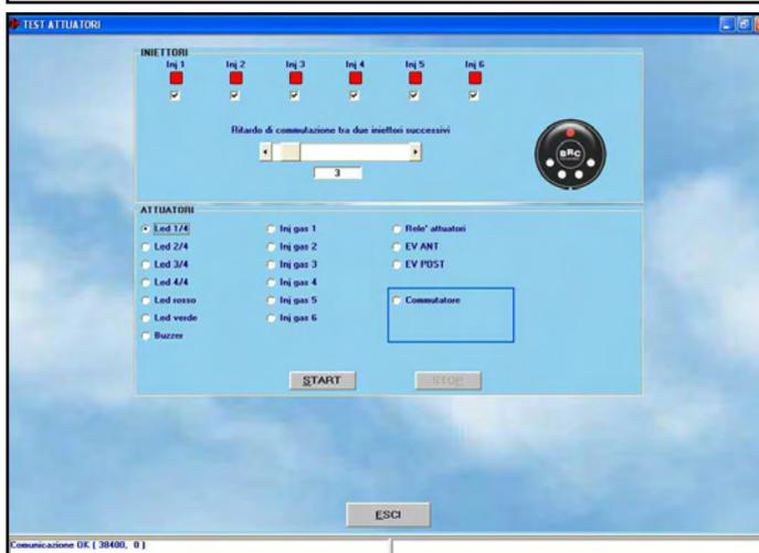
Fig. 6-14: Diagnostica - Test attuatori
