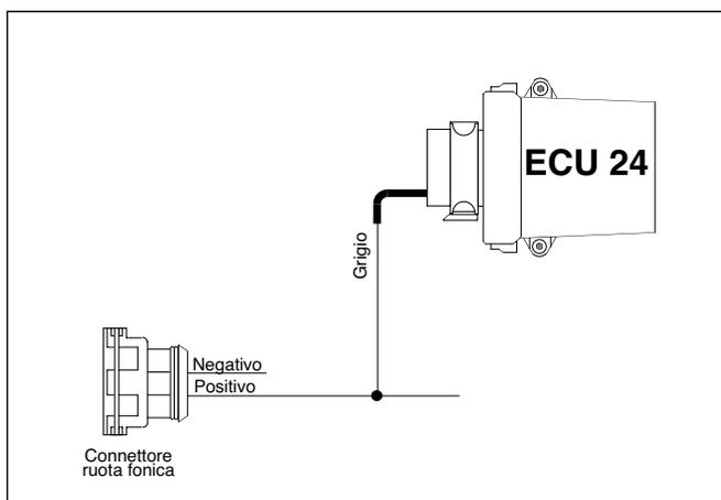
Fig. 26 Collegamento del filo Grigio con il segnale ruota fonica effetto Resistivo
