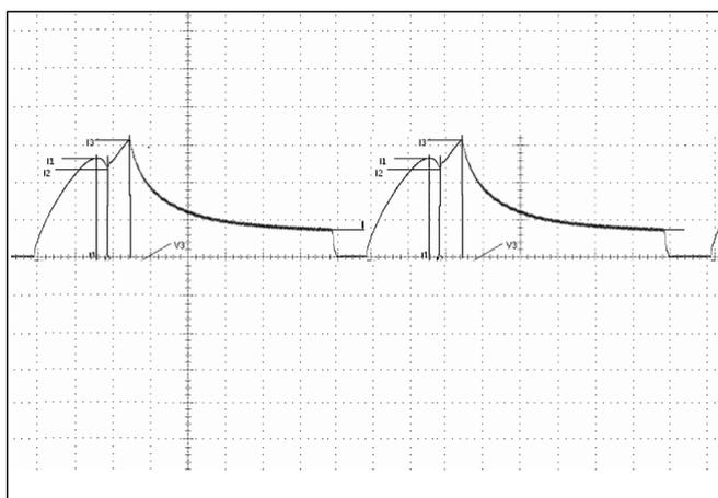
Fig. 28 Andamento della corrente nell'iniettore Keihin
