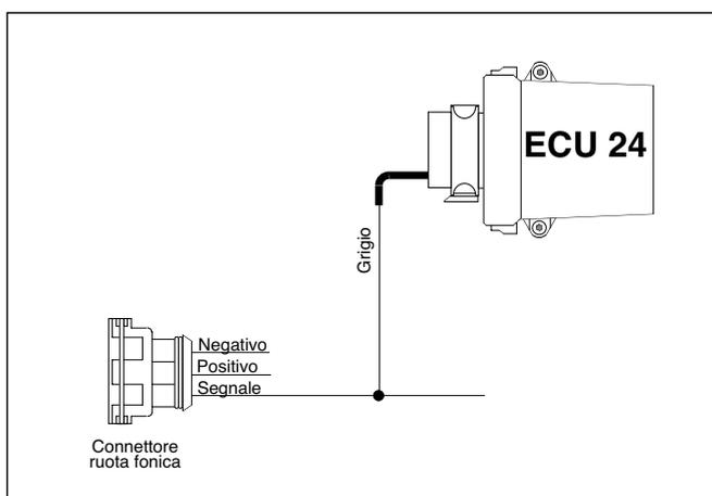
Fig. 27 Collegamento del filo Grigio con il segnale ruota fonica effetto Hall
