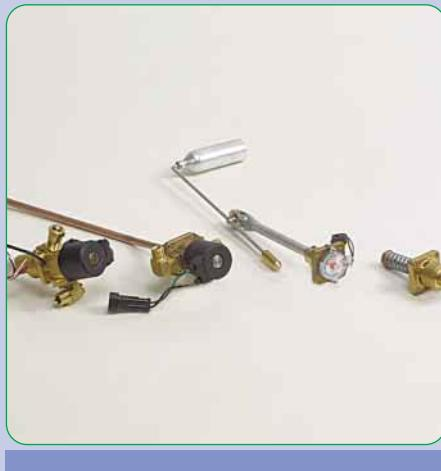
Niniejsze urządzenie składa się z czterech zaworów pełniących następujące funkcje: Tankowania z automatycznym elektronicznym ograniczeniem po osiągnięciu 80%, Poboru przy dużym przepływie (zawór i elektrozawór odcinający); Zaworu bezpieczeństwa na 27 barów i elementu nisko zanurzonego – wskaźnik poziomu.
