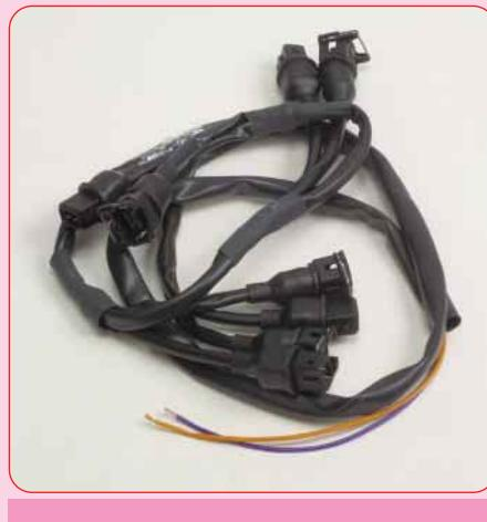
Okablowanie pozwala na odcięcie wtryskiwaczy bez konieczności odnalezienia przewodu nimi sterującego. Dostępne również w wersji do samochodów z silnikiem Boxer. Stosuje się z centralkami BRC do odcięcia wtryskiwaczy przy pomocy pomarańczowego i fioletowego przewodu.
